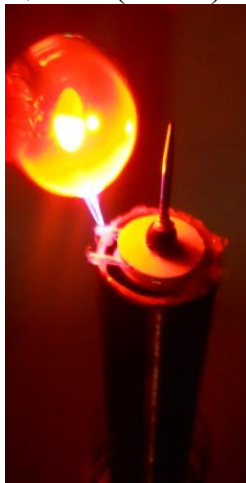
Рисунок 4. Возгорание газонаполненной лампы.
